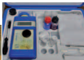
Testset für die regelmäßigen Wasserproben
